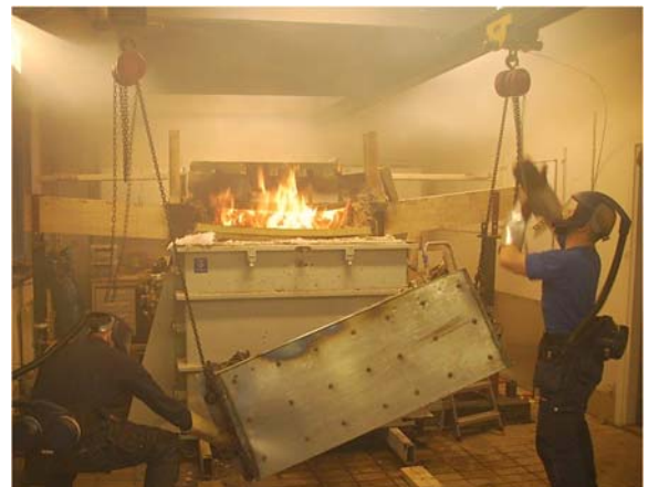
Foto: Brandversuch auf dem Horizontalofen in Stockholm an einem Brettschichtholzträger mit Belastung (STSM Simon Wynistorf, ETH Zürich, CH)
