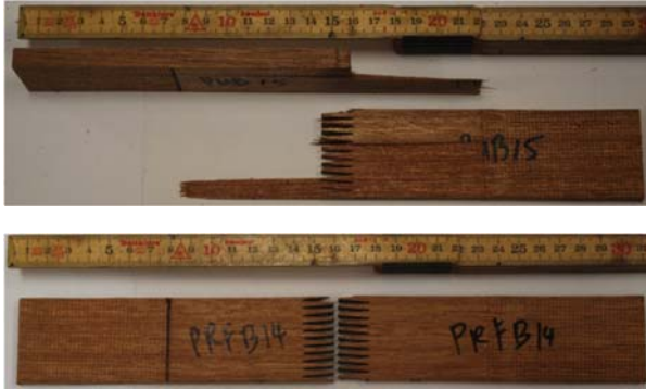
Foto: Benchmarkversuche mit Belastung an keilgezinkten Kleinkörpern mit einer neuen Testmethode. (STSM Chee Beng Ong, Universität Bath, UK)
